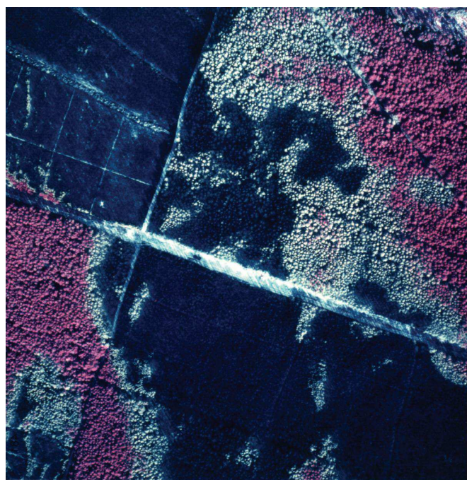
Obr. 1. Letecká infračervená snímka z oblasti Záhoria (film Kodak IRC 2443). Príklad určenia rozsahu a intenzity požiarov v borovicových porastoch
